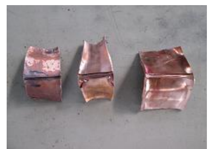
ろう付部を切断し内側評価
