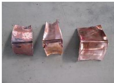
ろう付部を切断し内側評価
