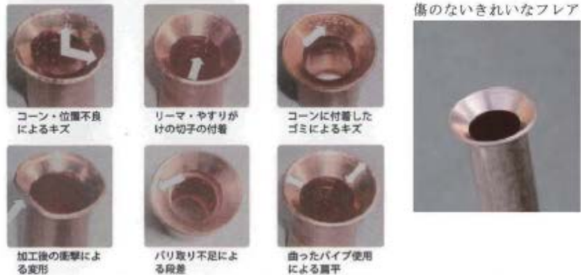
フレア加工面の状態例（異常状態のもの、きれいなもの）
