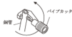
パイプカッタでの鋼管の切断
