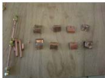
⑧ ろう付部のろう浸透評価
