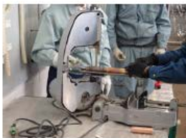
⑦ ろう付部の切断作業
