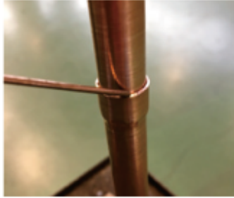
ろうは先端から接触させる
