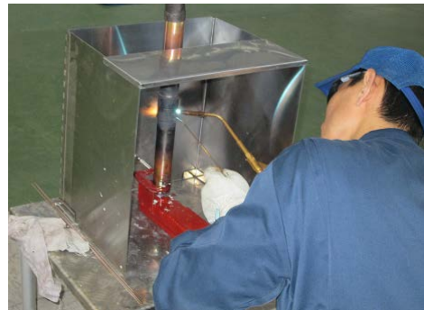
2日目 遮蔽板による前面ろう付け
