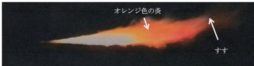
(a) 大気中のアセチレン燃焼炎（酸素は大気中からのみ供給）
