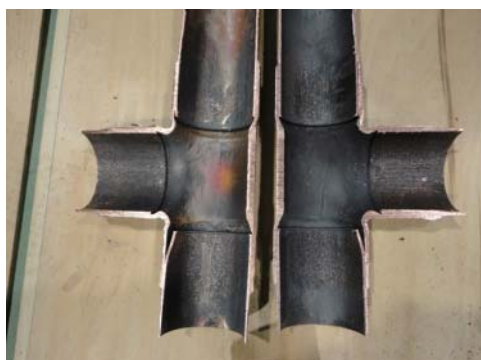
⑤ チーズ部切断面評価（浸透不良の例）
