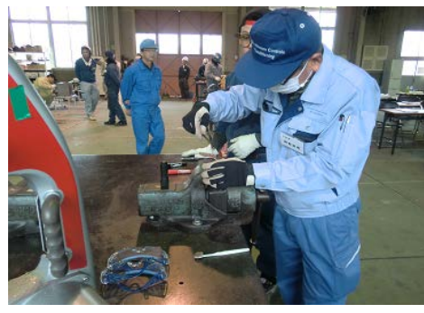
ろう付け加工部切断面の浸透確認
