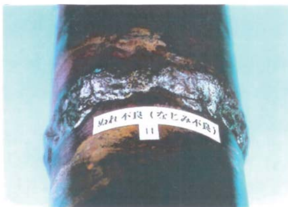
写真 (f) ぬれ不良 (なじみ不良)
