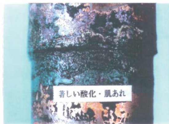
写真 (g) 表面の著しい酸化・肌あれ
