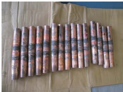
③ ソケット部切断面評価（浸透の良い例）
