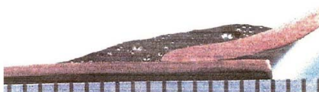
(b) 写真 (a) の試料中央部の断面マクロ組織写真
