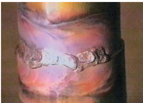
写真(j) ブレイズ溶接状のフィレット
