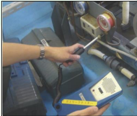
直接法による点検
