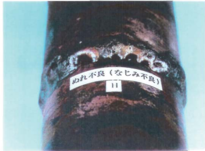
(e) ぬれ不良 (なじみ不良)
