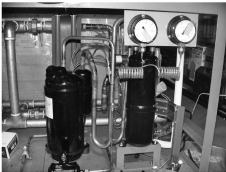
写真3 冷媒・水配管完了 気密試験中
