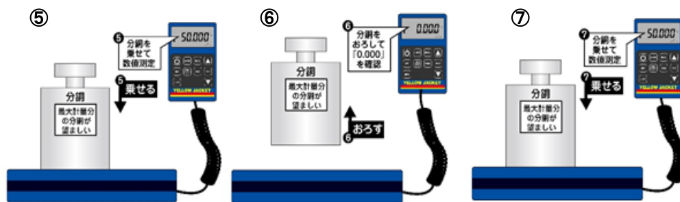
図 E.2 デジタルスケールの秤量付近再現性点検
