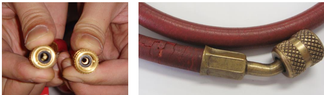
図 C.6 チャージングホースの劣化例（O リング、ひび割れ）
