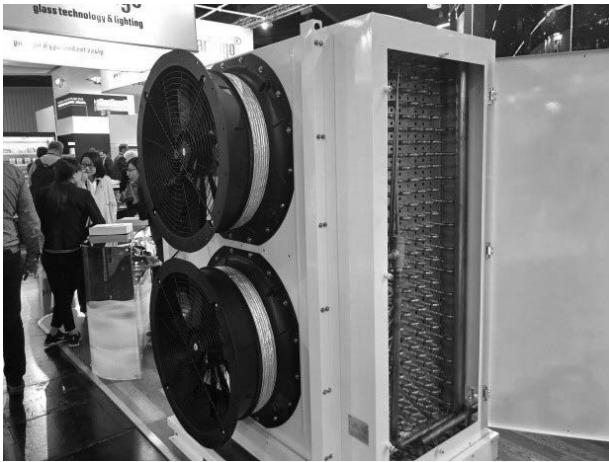
日本では見かけない送風機が横に付いた冷却塔
