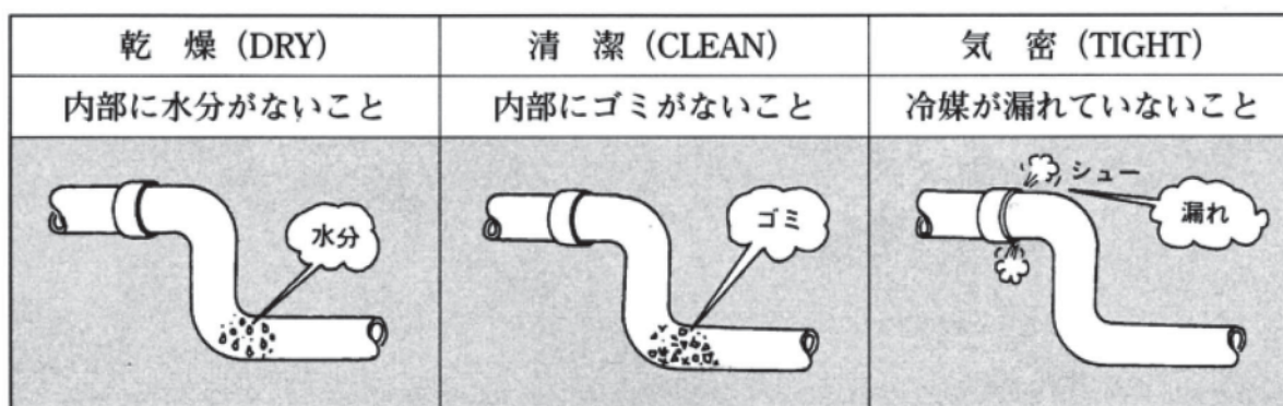
図1.1 冷媒配管施工3原則
