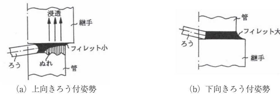
図4.38 ろうの浸透する状態の模式図
