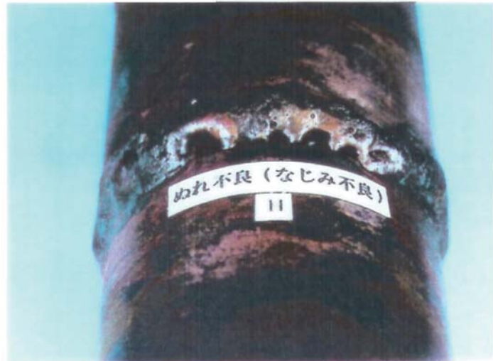
(e) ぬれ不良 (なじみ不良)
