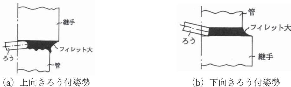
図4.39 良好なフィレットの状態
