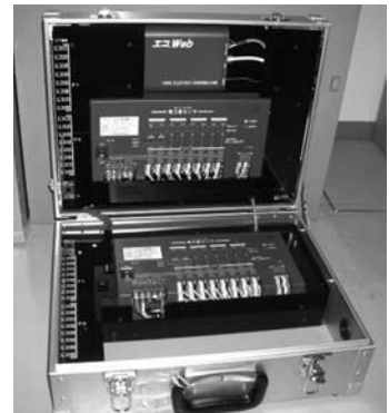
写真5 テンポラリ用電力量 計測装置
